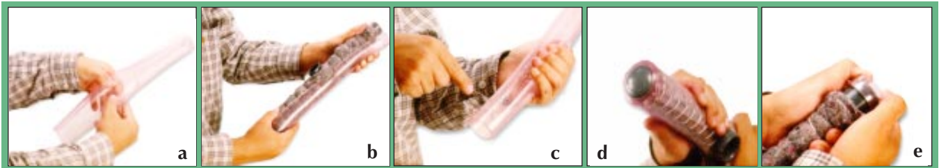
Figura 4. (a) Se utiliza una manguera plástica de 1 pulgada y media, cortada y perforada, la cual va a estar en contacto con las arvenses al momento de operar el equipo. (b) Se instala la manguera de plástico en el equipo a presión. (c) La manguera se perfora para que unte el follaje de las arvenses agresivas. (d) Amarre de la manguera perforada. (e) Los tapones se insertan en la T del selector para evitar el goteo de la mezcla herbicida.
