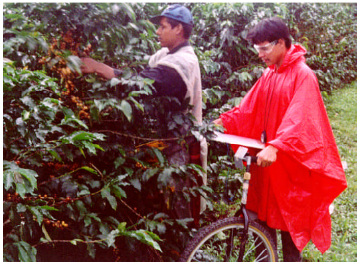
Figura 3. Monociclo con odómetro para la determinación del recorrido total por recolector
