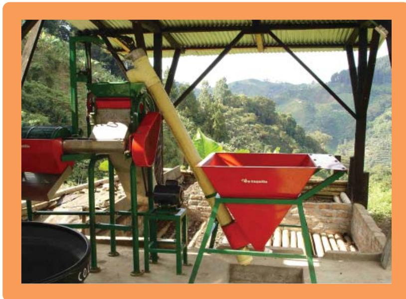
**Figura 6.** Separador hidráulico de tolva y tornillo sinfín desarrollado en Cenicafe por Oliveros y Col. (2007)
