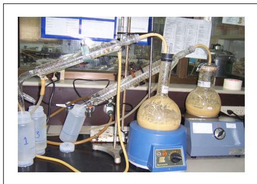
Figura 2. Destilación simple del fermentado.
