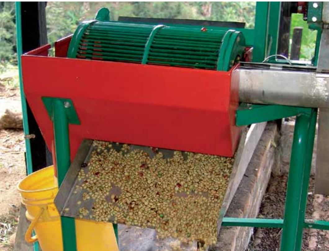
Figura 3. Zaranda cilíndrica de varillas.
