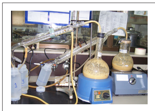
Figura 2. Destilación simple del fermentado.
