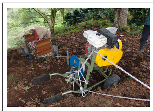
Figura 6. Equipo diseñado para transportar café en terrenos de alta pendiente.
