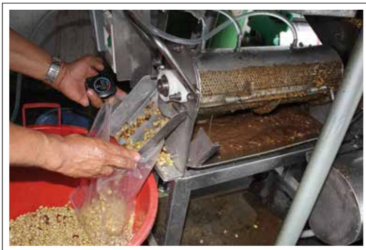
**Figura 4.** Medición en el lavador de la descarga de café.
