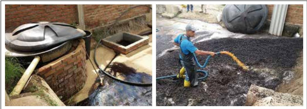
**Figura 4.** Tanques para recibo de mucilago concentrado desde la planta y de recolección de lixiviados (izq.) y riego de pulpa descompuesta con mucilago fresco (der.).
