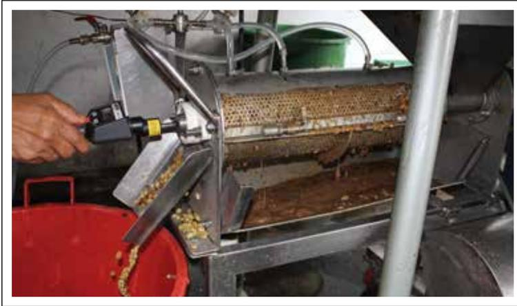
**Figura 2.** Medición de velocidad de giro del rotor del lavador.
