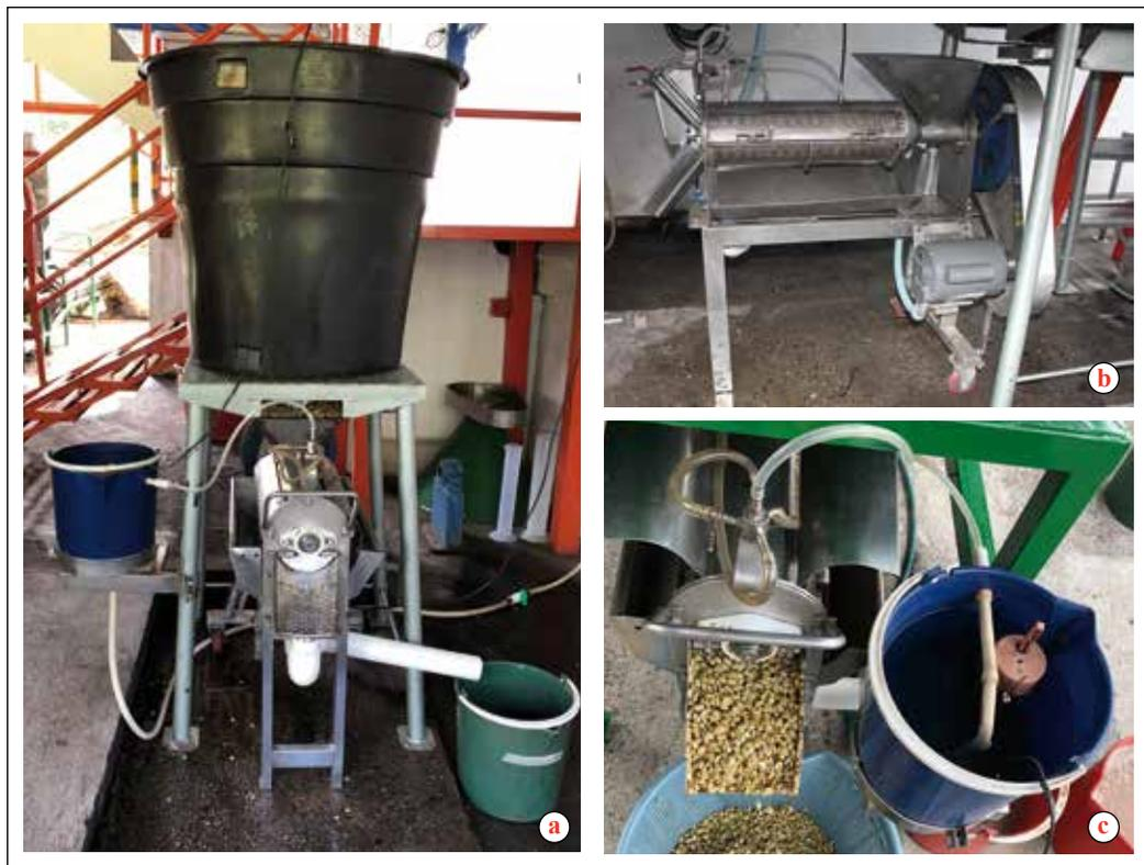
**Figura 1.** Equipo utilizado. a. Vista general; b. Lavador; c. Suministro de agua.
