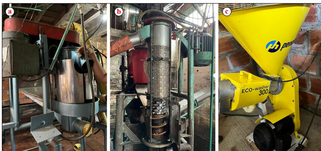
**Figura 8.** Desmucilaginosos mecánicos para remover el mucílago del café. a. Desmucilaginoso de varillas; b. Desmucilaginoso tipo DESLIM; c. Lavador mecánico de café con mucílago degradado.
