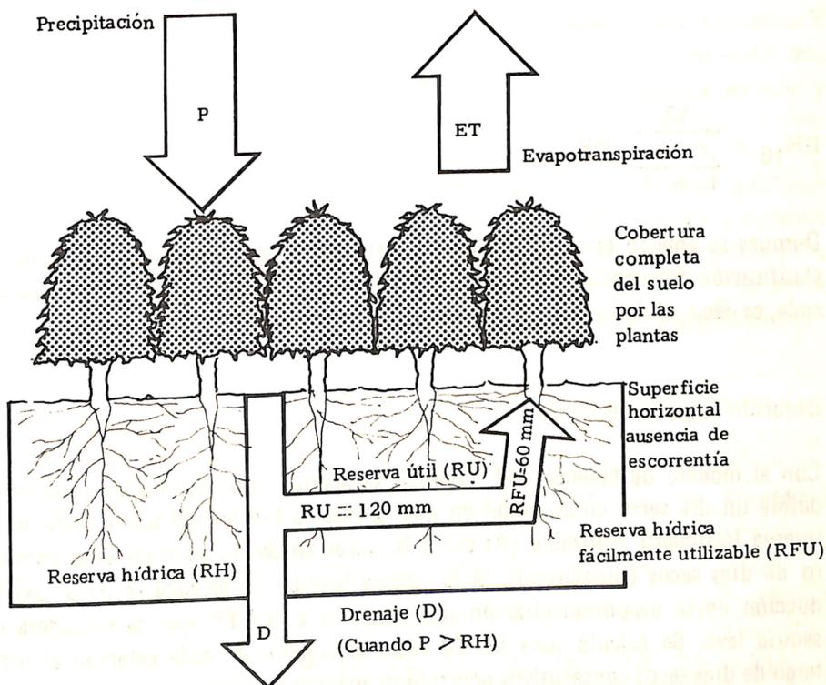
FIGURA 1 - Representación de los componentes del balance hídrico diario.
