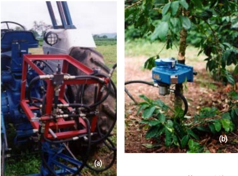
**Figura 1.** Prototipo para aplicar vibraciones multidireccionales. a) Fuente de potencia y sistema hidráulico. b) Mecanismo vibrador.
