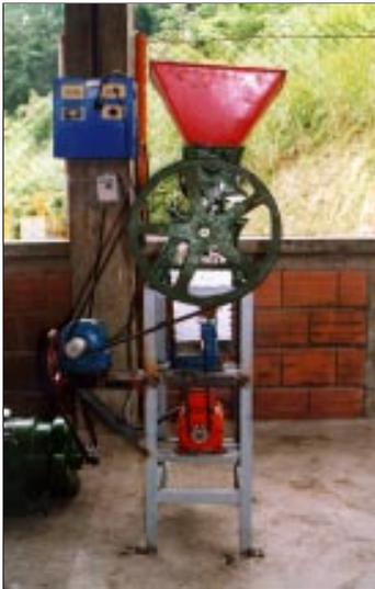
**Figura 9.** Prototipo separador de objetos duros en el café cereza cosechado. Cenicafé 1997.
