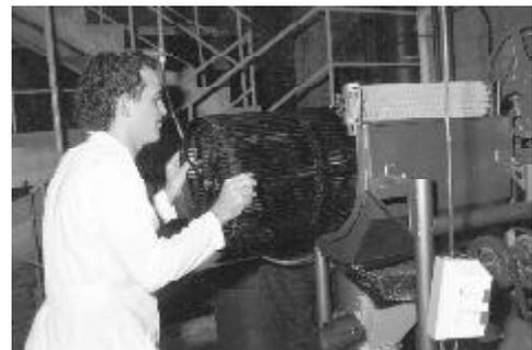
**Figura 3.** Zaranda circular de varillas empleada en el proceso tradicional del café.
