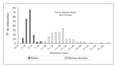
Figura 2. Distribución de frecuencias de la lluvia máxima (mm/24 horas) para la región Andina de Colombia.
