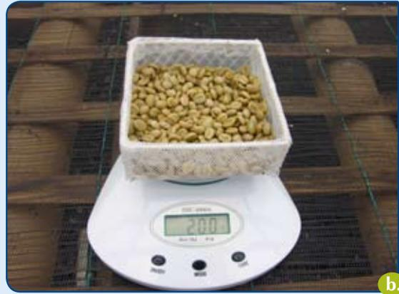
**Figura 9.** Método Gravimet para medir la humedad del café en secado solar. **a.** Canastilla y balanza utilizadas; **b.** Ubicación de la canastilla en el secador parabólico modificado
