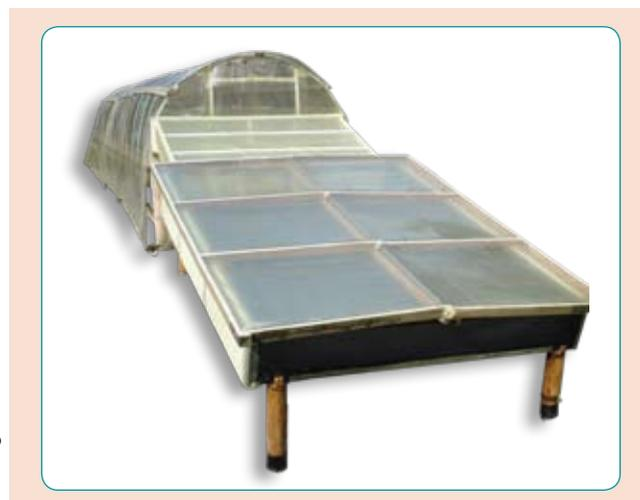
**Figura 8.** Secador tipo túnel con colector solar.
