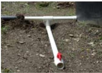
Figura 3. Válvula para purga de aire o gas.
