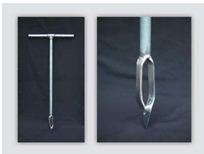
Figura 7. Barreno tipo holandés, para tomar muestras de suelo.
