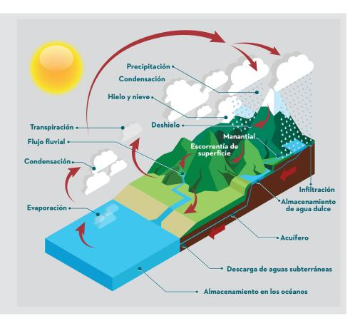
Figura 57. Componentes del balance hidrológico dentro de una cuenca.
