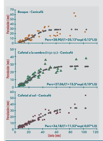
Figura 64. Relación entre la percolación y la lluvia externa para diferentes coberturas vegetales (Jaramillo-Chaves 1998, 1999).
