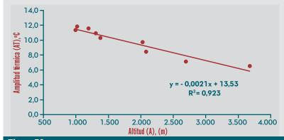
Figura 36. Variación de la amplitud térmica con la altitud para la cuenca del río Chinchiná-Caldas.
