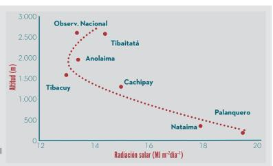
Figura 26. Variación de la radiación solar con la altitud. Cuenca del río Magdalena. cordillera Oriental, vertiente Occidental.
