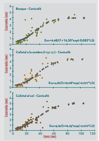
Figura 63. Relación entre la escorrentía medida en predios en diferentes coberturas vegetales y la lluvia externa (Jaramillo-Chaves 1998, 1999).
