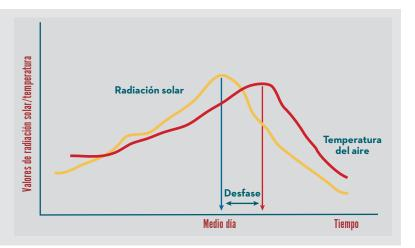
Figura 33. La radiación solar y la respuesta de la temperatura del aire durante el día.
