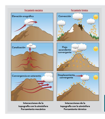
**Figura 15.**Mecanismos de interacción de la topografía con la atmósfera. Forzamientos mecánico y térmico (Whiteman, 2000).
