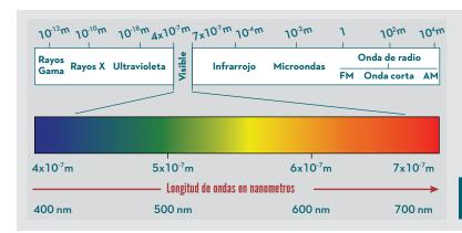
Figura 20. Longitudes de onda de la radiación solar.
