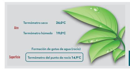
Figura 47. Formación del rocío y la temperatura del punto de rocío.
