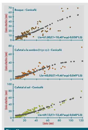
Figura 62. Relación entre la lluvia que ingresa al suelo (lluvia efectiva) y la lluvia externa, para diferentes coberturas vegetales (Jaramillo-Chaves 1998, 1999).
