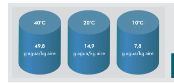
Figura 46. Capacidad de retención de humedad a saturación (100% humedad relativa) de una masa de aire con la temperatura.
